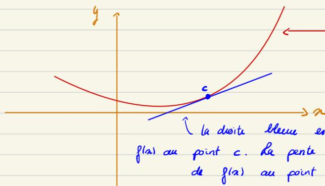
La droite bleue est la tangente de la courbe de  $f(x)$  au point  $c$ . La pente de cette tangente, c'est la dérivée de  $f(x)$  au point  $c$ .
